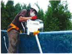
森林タワーにおけるポータブルゲルマニウム検出器を用いた放射能測定
