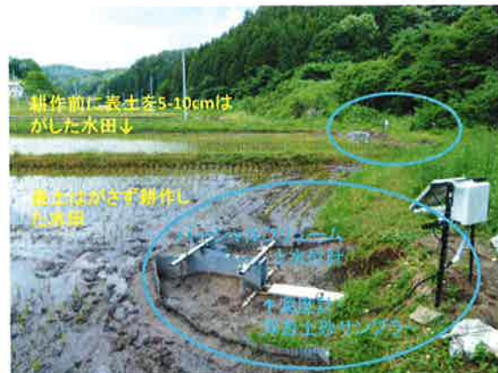
土壌下方浸透スクレーパープレートによる5mm間隔詳細深度分布(8カ所で採取済み)
